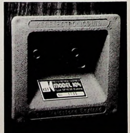
Aansluitingen bij de 104 zowel Din als banaan!
